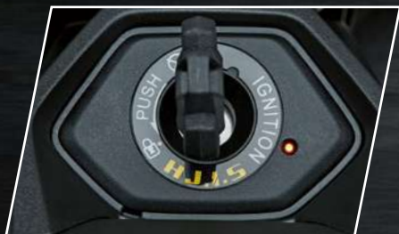
Sistema antirrobo HJS Sistema inmovilizador HAOJUE con chip de seguridad
