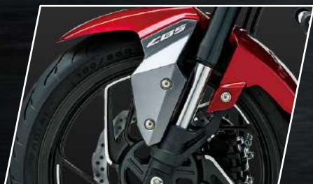
Sistema de frenado inteligente CBS (Combined Braking System)
